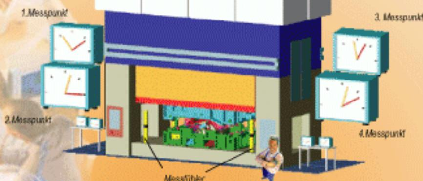
Nach Messung der tatsächlichen Presskraft über vier Messpunkte wird Ihre Hydraulische Überlastsicherung dynamisch von uns auf die für Werkzeug und Presse richtigen Werte justiert.
