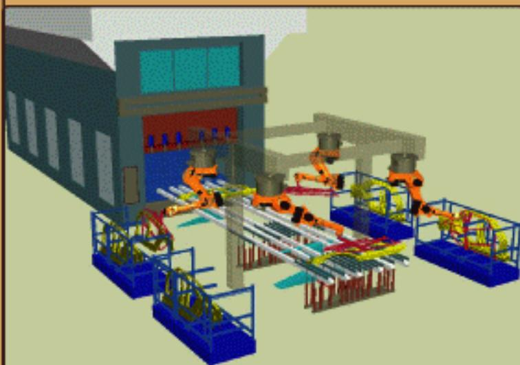
Die Darstellung der Teileentsorgung an Cross bar - Pressen und an einzelnen Pressenkomplexen wird in einer Echtzeit-Simulation durchgeführt und nachfolgend optimiert. Die Simulation zeigt, dass kollisionskritische Bewegungen vermieden werden und Bewegungsbahnen der beteiligten Mechanismen optimiert werden. Dies führt zu einer nicht unerheblichen Leistungserhöhung des Gesamtsystems.
